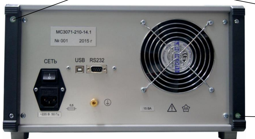
Рисунок 2 – Схема пломбировки от несанкционированного доступа, обозначение мест нанесения знаков поверки
